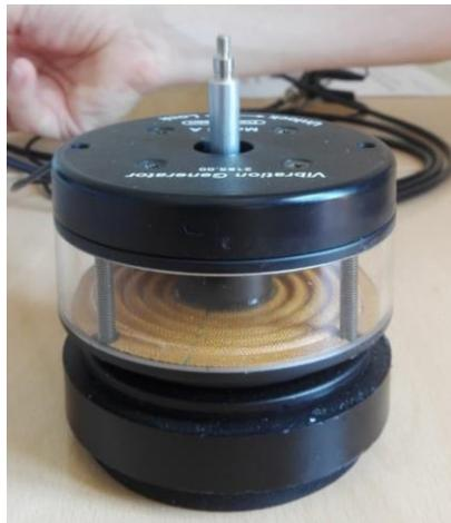
Figura 2.2-1 Generador de vibraciones
